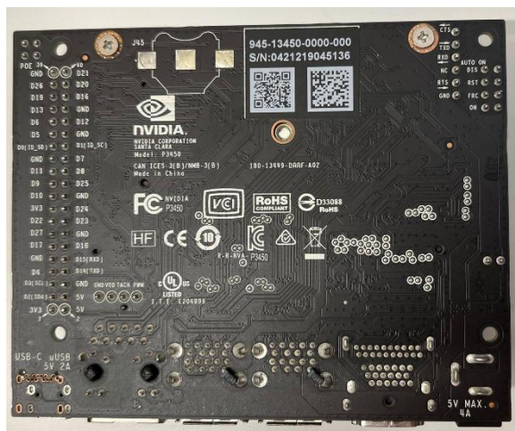
Figura 5. Vista inferior de la placa con serigrafía de pines GPIO. Fuente: Elaboración propia
